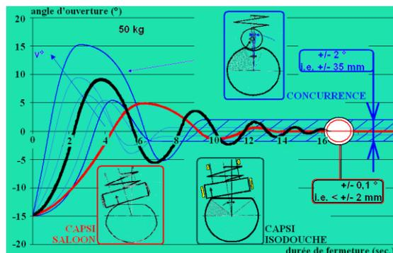
Cycles de fermeture et oscillations de la porte avec une CAPSI Isodouche et une charnière à indexage. Précision / Imprécision de fermeture.
