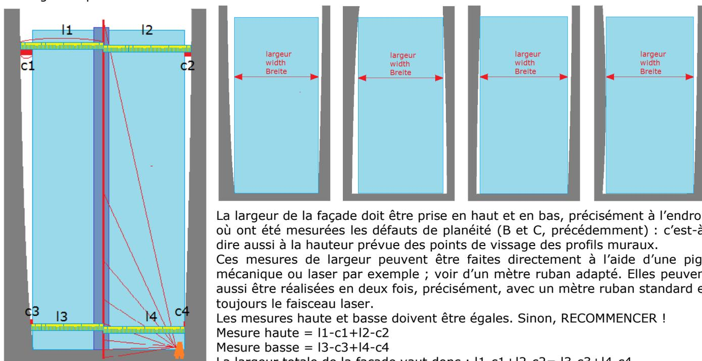
La largeur de la façade doit être prise en haut et en bas, précisément à l'endroit où ont été mesurées les défauts de planéité (B et C, précédemment) : c'est-à-dire aussi à la hauteur prévue des points de vissage des profils muraux.
