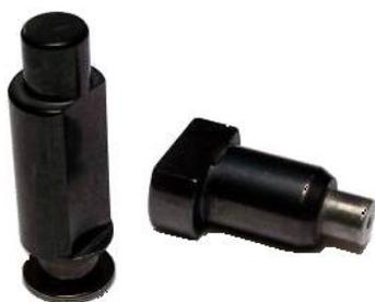
Pour la meilleure précision de rappel, les pistons de CAPSI sont métalliques. Cela leur confère la rigidité nécessaire à un guidage parfait et le maintien de la face d'appui du piston à mieux que 0,1° près par rapport au plan de la porte. Dès lors que le piston est métallique, piston et came doivent être réalisés en métal extrêmement dur pour supporter les contraintes de contact en jeu et ne jamais s'écailler. En acier, les niveaux de dureté requis sont de l'ordre de 1.500 MPa.
