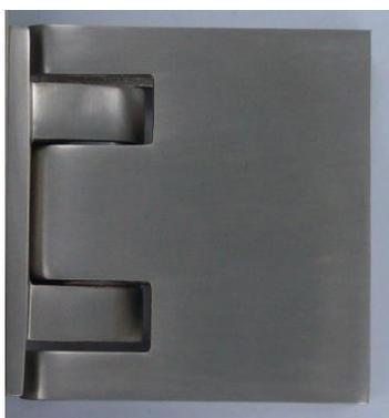
REVERSI bénéficie du même mécanisme que CAPSI. Tous les éléments constructifs sont identiques, à la contreplaque près qui ne comporte dans la REVERSI plus de lamage pour loger les cache-vis. Pour la REVERSI, l'assemblage de la plaque moteur et de la contreplaque est inversé par rapport à celui d'une CAPSI : pour revenir à un montage usuel avec vis apparentes côté intérieur.
