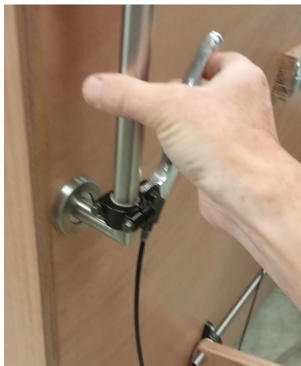
Déverrouiller la position inclinée en manœuvrant la manette type « frein de vélo » et basculer la table à l'horizontale. Une fois la manette relâchée, la table se bloque en position horizontale.
