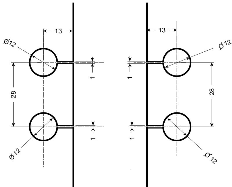
Montage avec trous débouchés : perçages identiques pour les deux modèles
