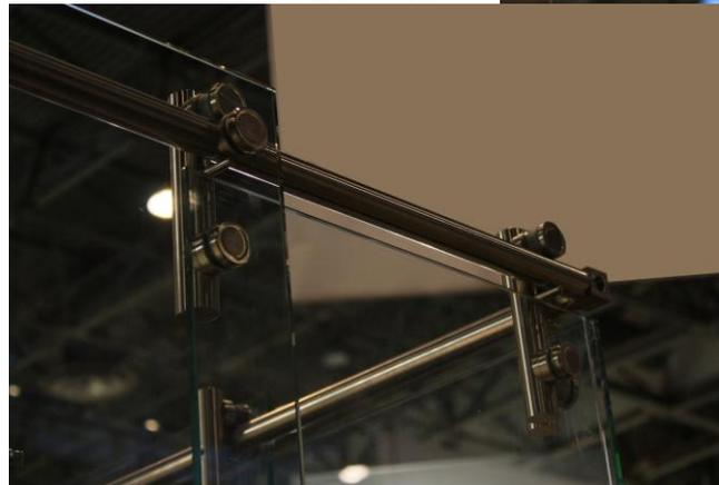
Système en inox pour la réalisation de façades simples, sans suspension sous plafond ni raidisseur verre, jusqu'à 1m00 de côté ; et en niche jusqu'à 2m30.
